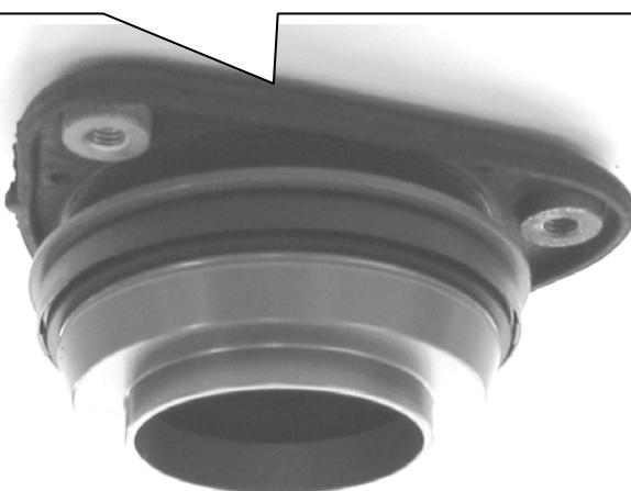
Original Axiallagereinheit entfernen.
