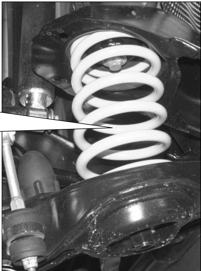
Zwischen Feder und Höhenverstellung wird die mitgelieferte Gleitscheibe eingelegt. Feder mit der geschliffenen Seite auf die Höhenverstellung setzen. Zum korrigieren der Fahrzeughöhe ist die Feder zu entlasten gegebenenfalls zu demontieren.
