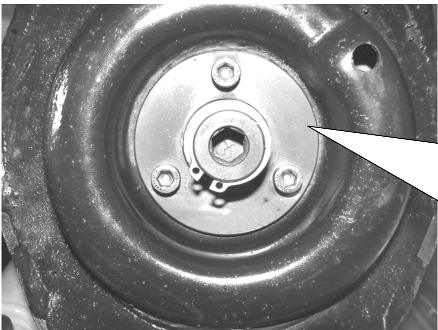
Angelieferten HA-Verstellung von der Befestigungsplatte demontieren (durch Entfernen der drei Befestigungsschrauben und des Sicherungsringes). Höhenverstellung von oben in den Querlenker einsetzen und verschrauben wie im Bild dargestellt. Anzugsdrehmoment der Verschraubung: 10 Nm.
