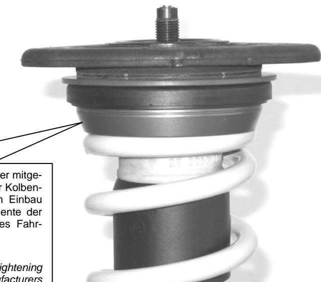
Nach erfolgtem Einbau des Fahrwerkes ist die Freigängigkeit der Bereifung zum VA- Federbein zu überprüfen. Das Mindestabstandsmaß an der engsten Stelle darf **5 mm** nicht unterschreiten und ist gegebenenfalls mittels handelsüblicher, TÜV geprüfter Distanzscheiben wieder herzustellen.
