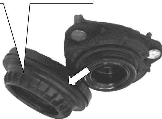
Das Original Domlager auf das Federbein aufzusetzen, und mit der mitgelieferten Stoppmutter verschrauben. Das Anzugsdrehmoment der Kolbenstangenbefestigung beträgt 35 Nm. Die Montagehinweise zum Einbau des Federbeines in das Fahrzeug, sowie die Anzugsdrehmomente der Federbeinbefestigung, entnehmen Sie bitte den Unterlagen des Fahrzeugherstellers.
